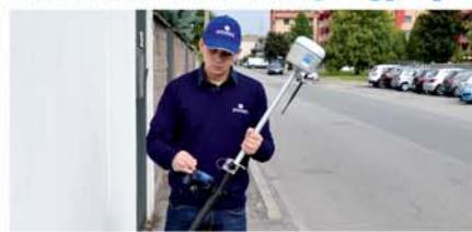
اندازه گیری کنج ها و لبه های دیوارها سیار آسان خواهد بود حکمرانی داخلی می تواند مختصات نقاطی را که با زاویه و یا چهت شب دار جمع اوری شده اند، تصویر نمایند.
